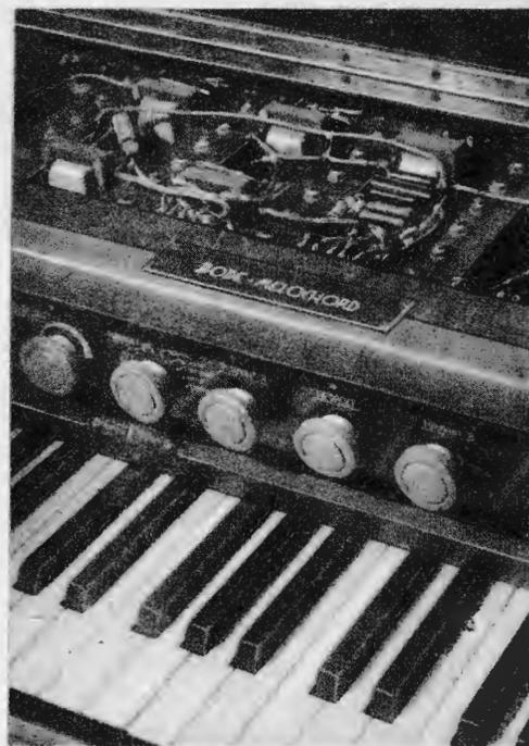
Bild 3. Innenansicht des Instruments bei aufgeklapptem Deckel. Man erkennt die Querleisten mit den Potentiometern für die Abstimmung der einzelnen Tonintervalle und einen Teil der Klangfilter
