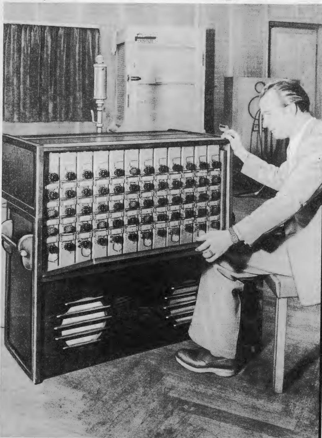
Der Bayerische Rundfunk verwendet seit einiger Zeit im Hörspiel und für Unterhaltungssendungen das „Bode-Polychord“, die neueste deutsche elektronische Kleinstorgel. Auf engstem Raum sind in diesem Instrument die Röhrengeneratoren, Klangfilter, Register, Vibratoeinrichtung, Netzteile, der Verstärker mit einer Leistung von 25 Watt und die Lautsprecher untergebracht. Unser Bild vermittelt einen Blick auf die 60 Tongeneratoren bei geöffneter Rückwand.
